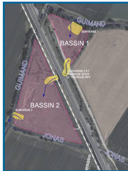
Figure 1 : Fonctionnement du bassin de Fauconnières
